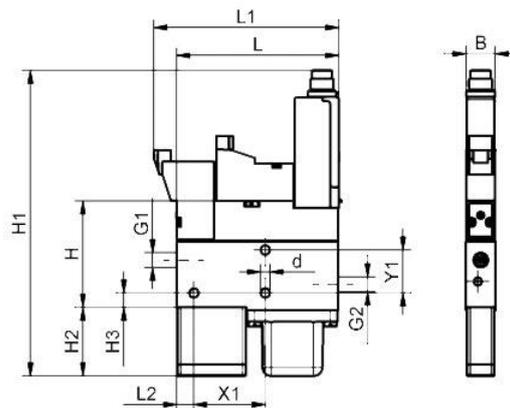
**Mini-Kompaktejektoren, Typ »Mini Pump«, Systemüberwachung: digitaler Vakuumschalter mit Teachfunktion**
