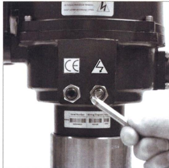
Anschlagbolzen nach rechts anziehen.
